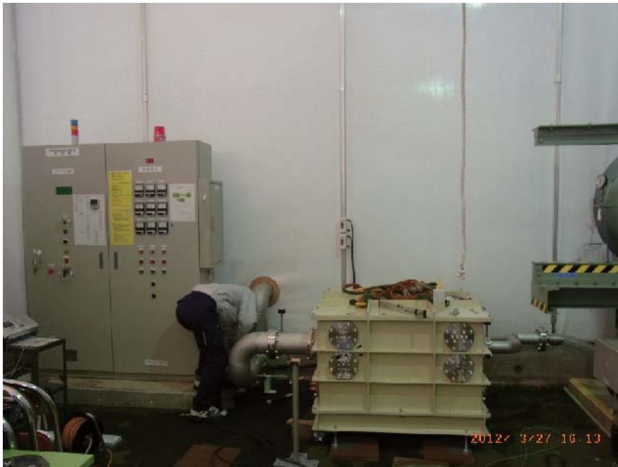
反転軸流ファン実験装置（中型超音速風洞設備内に設置）
