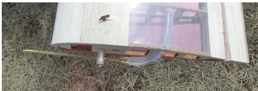
図4 左翼端に取り付けた5孔ピトー管
