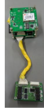
(b) スロットル制御信号収録器 (Sylphide)
