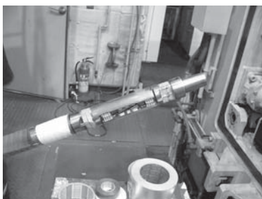
図6 6分力内装天秤；機体模型の内部に固定。
