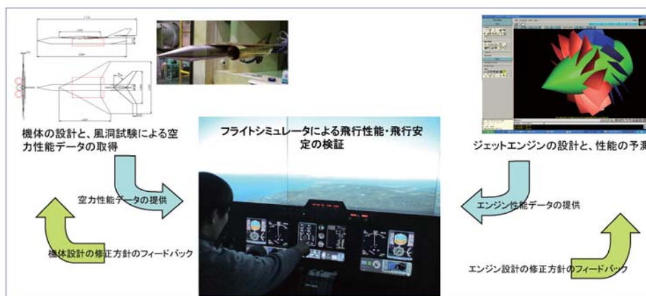
図 2：フライトシミュレーター装置を用いた小型超音速飛行実験機の研究・開発手順
