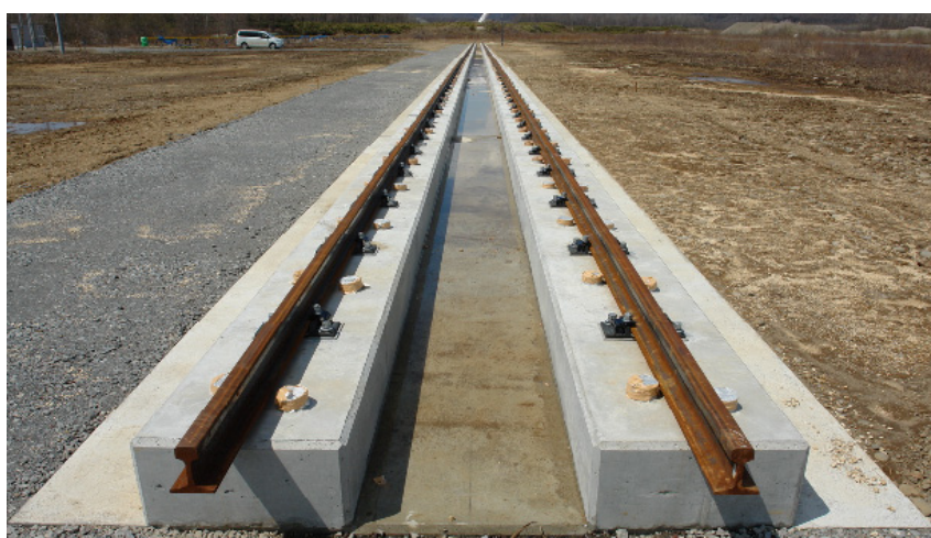
図 2 フルスケール高速走行軌道装置
