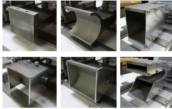
図 4：6 種類の水制動バケット（上段：壁なし 下段：壁あり）（左列：平板バケット 中列：半円筒バケット 右列：U字バケット）
