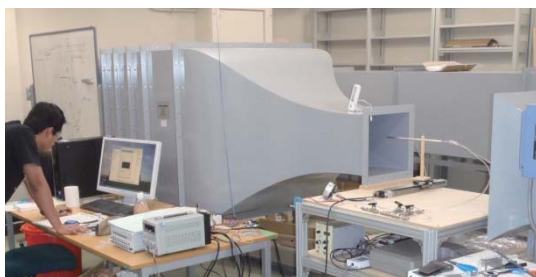
図3-5 5孔ピトー管の較正試験
