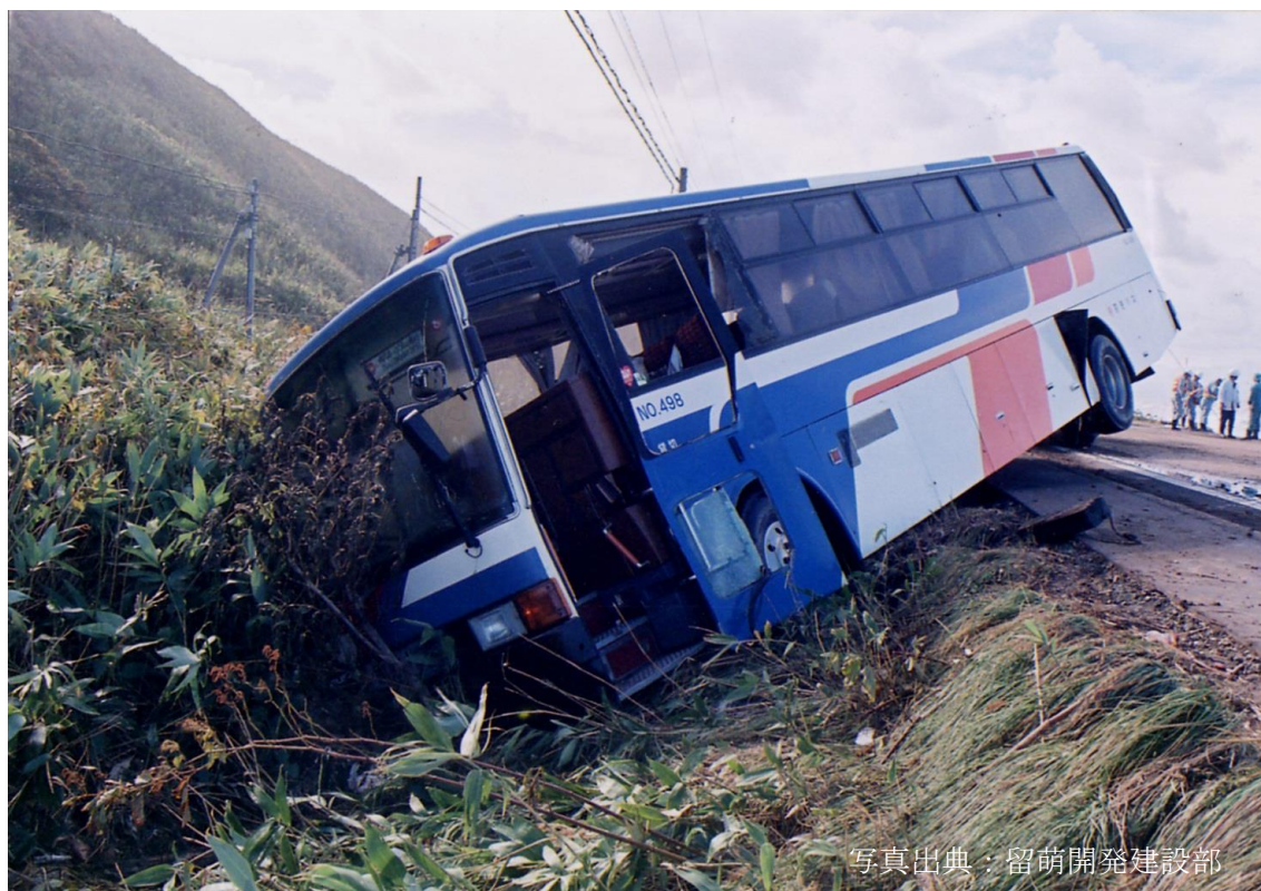
写真-3.3.2.1 越波により脱輪したバス車両
