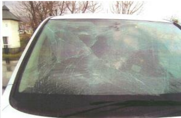
写真-1.2.3.4 越波水の打込みによる走行車両フロントガラスの破損
