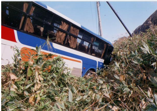
写真-1.2.3.5 船揚場斜路からの越波水の直撃による走行車両の脱輪
