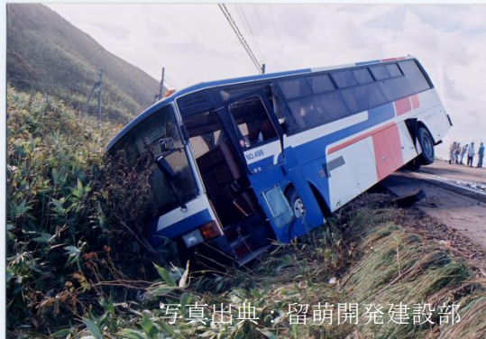
写真-1.2.3.5 船揚場斜路からの越波水の直撃による走行車両の脱輪
