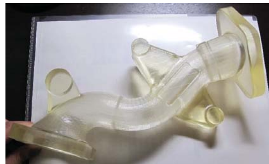
図1 3Dプリンタで製作した模型
