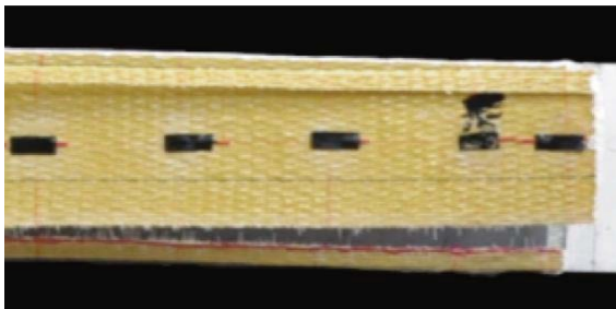
写真 5 A830-S 試験体のシートの断裂・剥離状況
