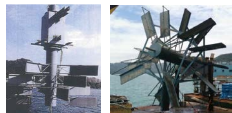
図 7 使用した多段式開閉型水車
