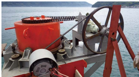
図 3 水車と発電機を繋ぐ回路
