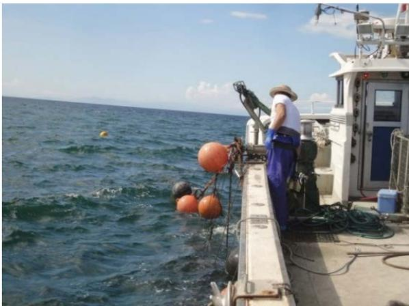
図4 海中への浸漬試験
