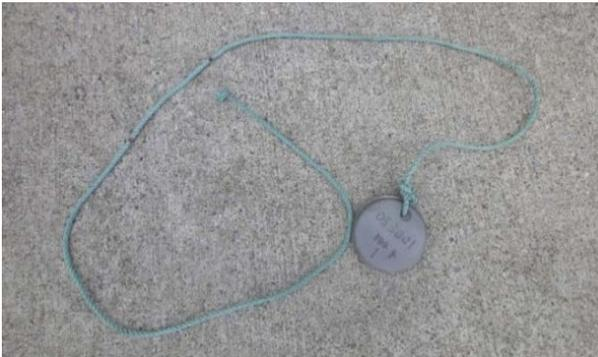
図3 ロープによる試験片の固定
