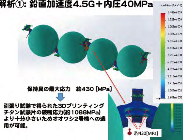
図 1 1 高圧気蓄器保持金具の解析条件
