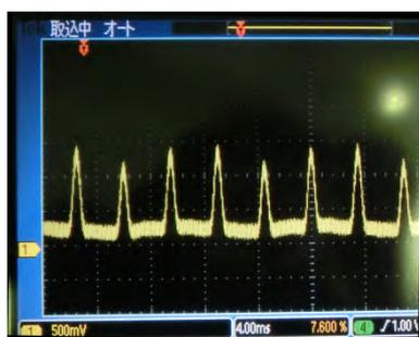
図4 軸変位センサの出力（回転数低）
