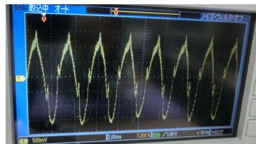
図5 軸変位センサの出力（回転数高）
