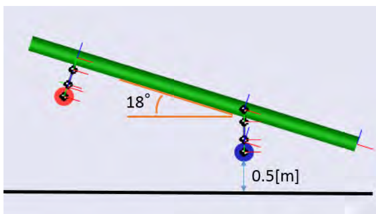
図5 迎角に合わせて傾けた胴体固定型主脚構造案
