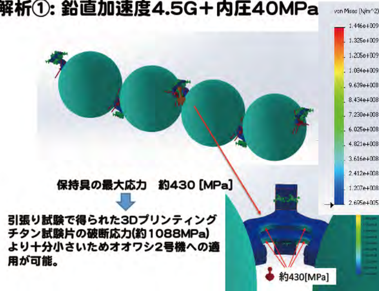
図 1 1 高圧気蓄器保持金具の解析条件
