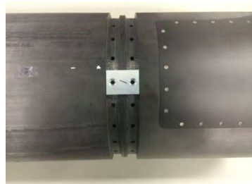
(c) マルマンクランプコマによる胴体結合
