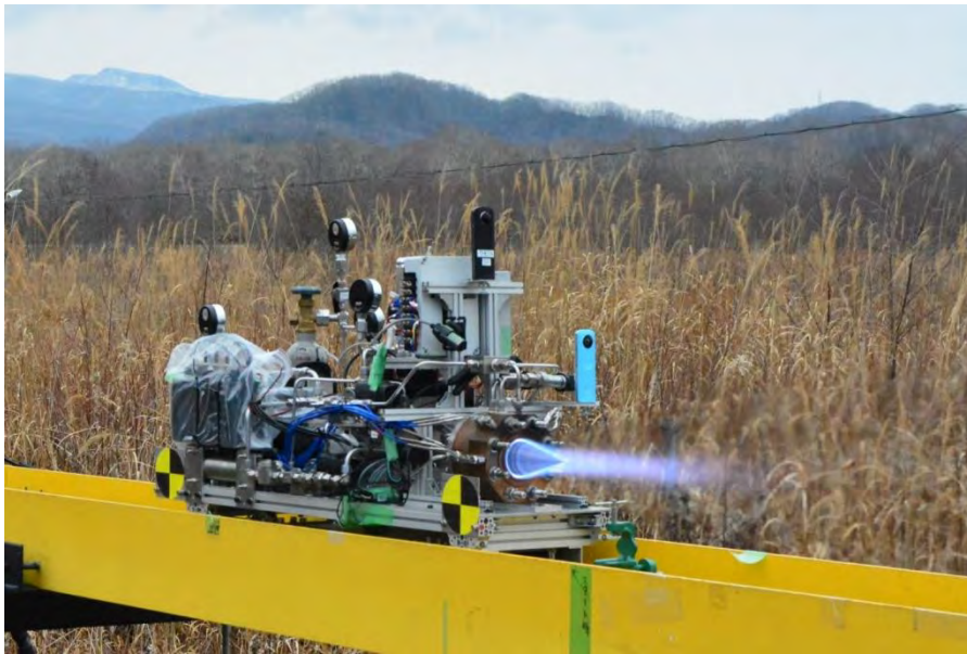
図2 名古屋大学 Rotating Detonation Engine の滑走試験
