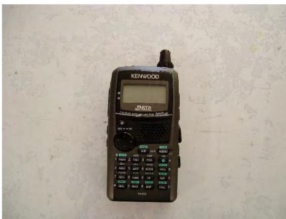
図 2 改造開発したコマンド送信装置
