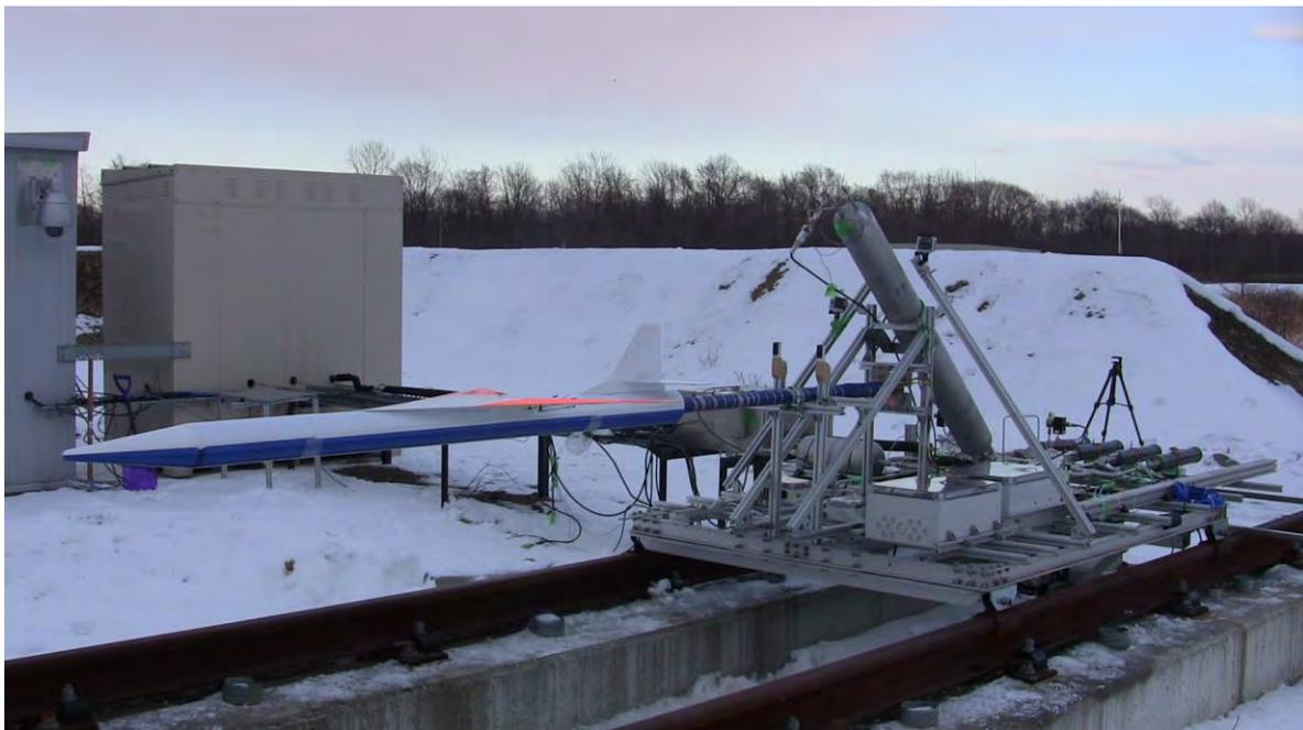
図1 ミニオオワシ搭載走行試験 (2016年1月24日, RUN026)
