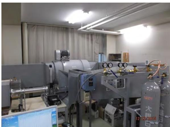
図4 回流式低速風洞外観
