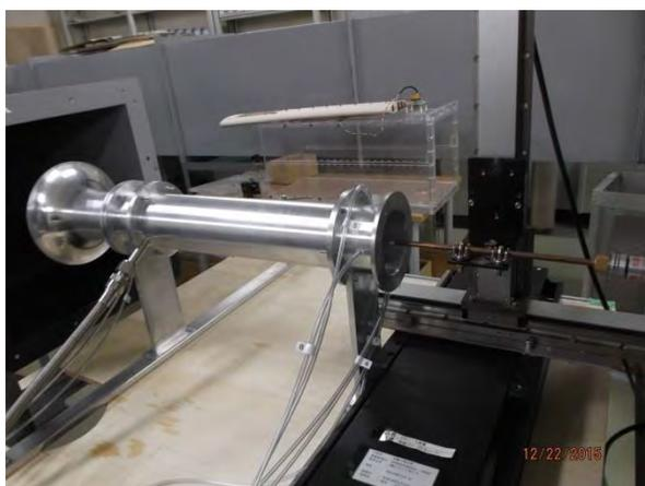
図5 ミキサー風洞試験モデル
