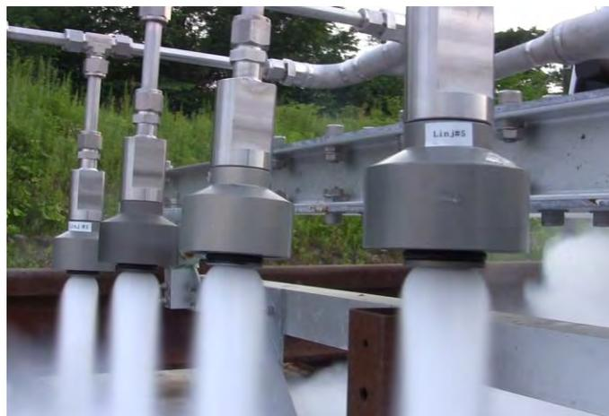
図4 亜酸化窒素コールドフローテスト
