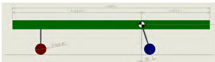
図5 迎角に合わせて傾けた胴体固定型主脚構造案
