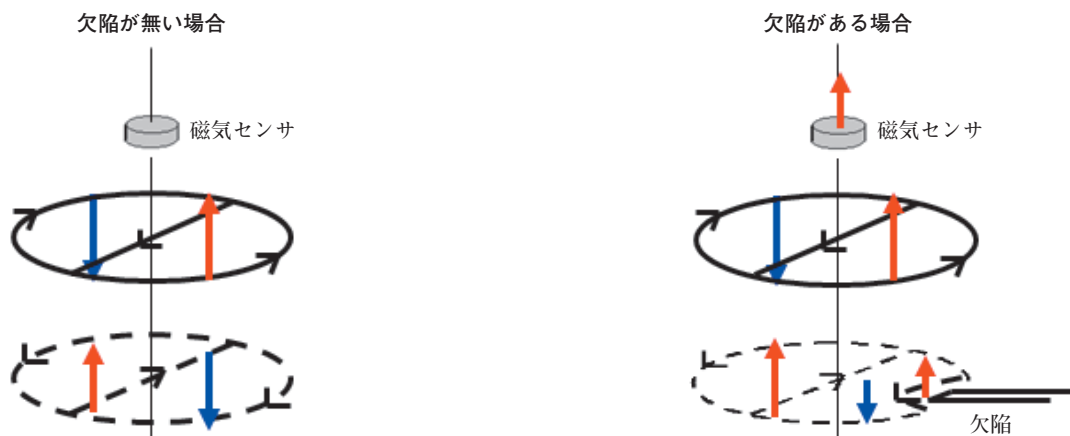
渦電流による磁界の左右のバランスがとれているので磁気センサは磁界を検出しない
