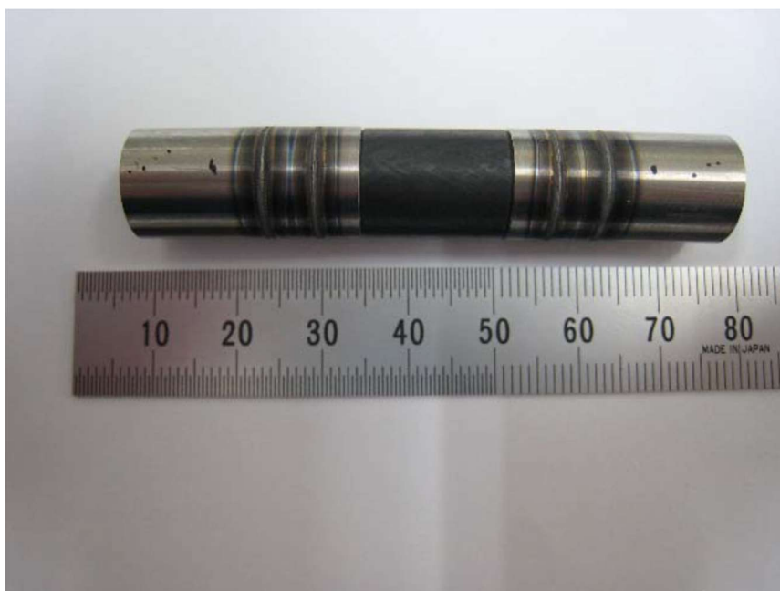
図 6.4.2 レーザー溶接後の SiC/SiC-Zry 接合試料外観
