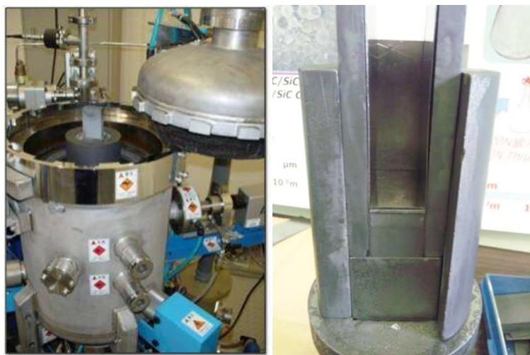
図 3.2.1. 多目的高温炉(FVPHP-R-5 型)の外観および冶具の組み立ての様子
