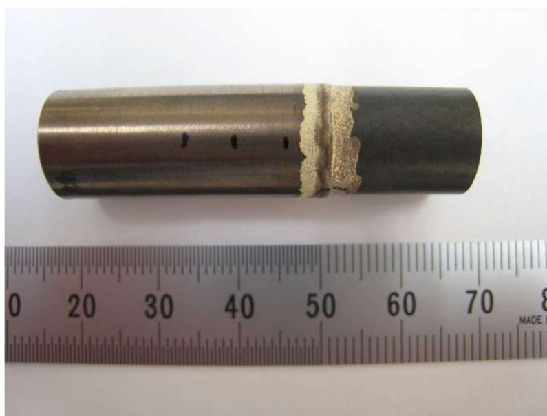
図 6.3.1 ろう付け後の試料外観
