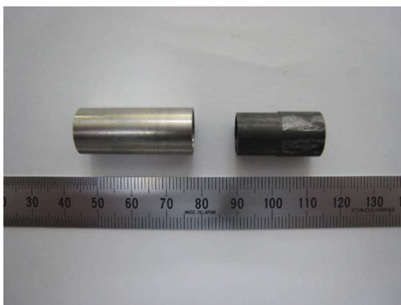
図 6.4.1.溶接前の SiC/SiC 管およびジルカロイ管
