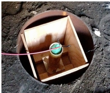
図 4-1 LSGT の試験装置と試験セットアップ写真
