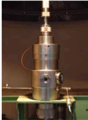
図 4-7 線燃焼速度計測試験装置
