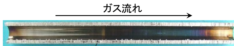
図 2-9 試験後供試体内表面写真
