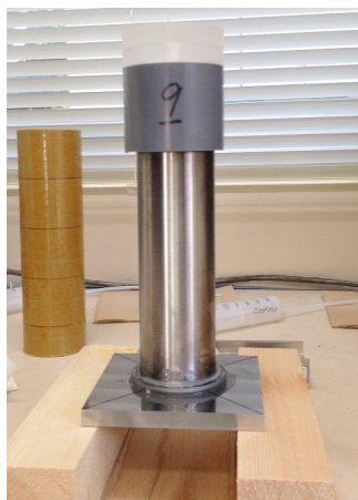
図 4-1 LSGT の試験装置と試験セットアップ写真
