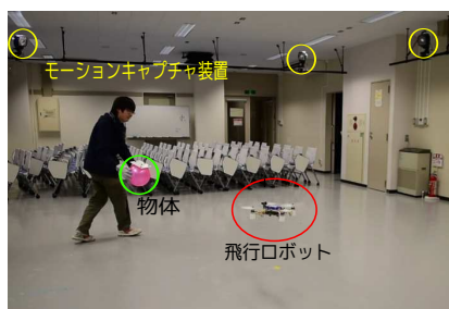
図3: 飛行実験スナップショット. モーションキャプチャー装置 (MoCap) は, 飛行結果の測定に用いた. 自律飛行制御に MoCap は用いていない.
