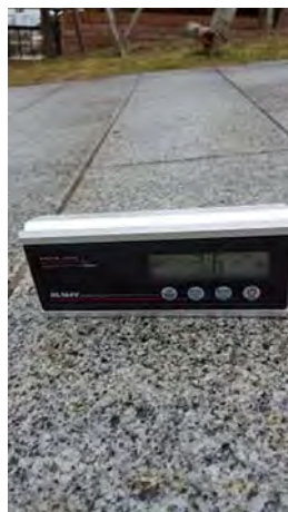
図 28 旧函館区公会堂からバス停へ向かう下り傾斜路の勾配計測
