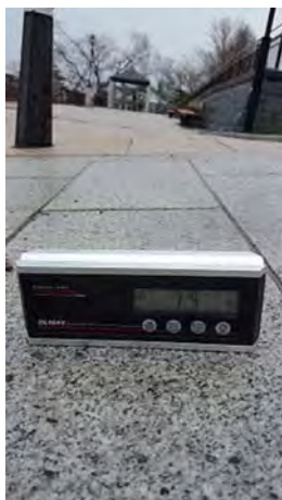
図 28 旧函館区公会堂からバス停へ向かう下り傾斜路の勾配計測
