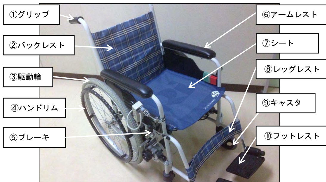
図3 車いすの構造と各部の名称
