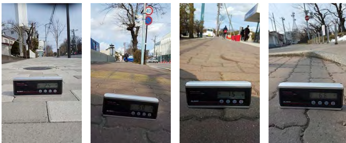
図 23 走行路面の勾配計測
