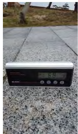
図 28 旧函館区公会堂からバス停へ向かう下り傾斜路の勾配計測
