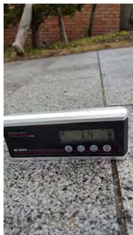
図 28 旧函館区公会堂からバス停へ向かう下り傾斜路の勾配計測
