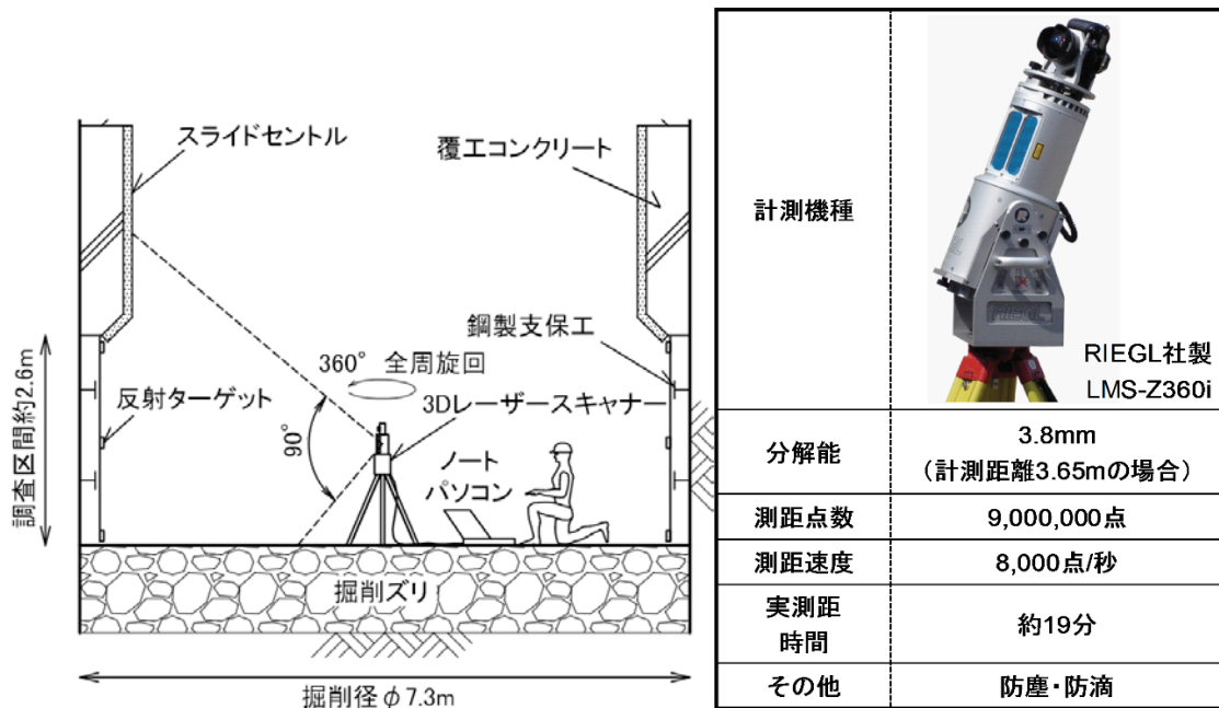
図 2.2-2 主立坑におけるレーザー計測概要とスキャナ本体の主な仕様 (持田ほか (2007) に基づく)
