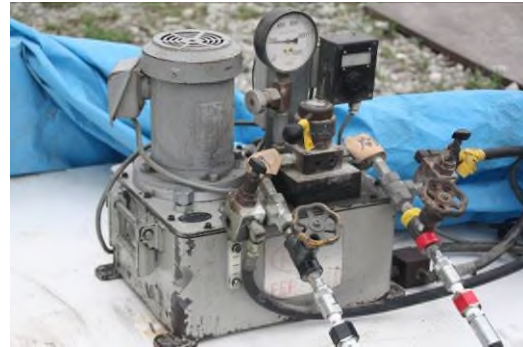
写真-4.22 油圧ポンプ
