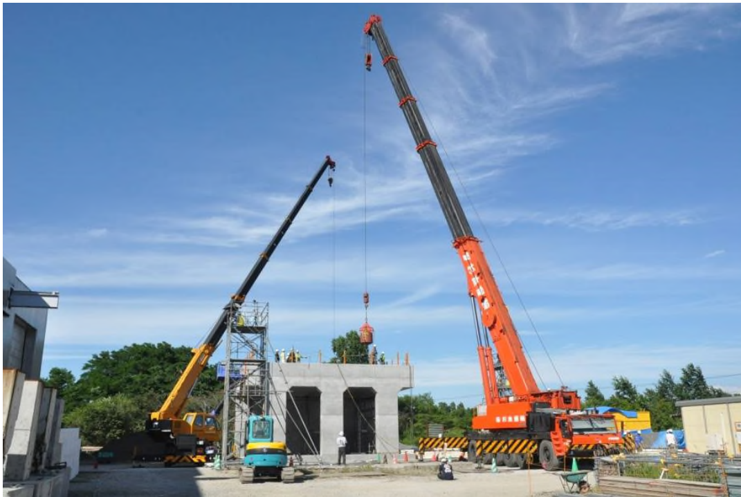
写真-4.2 実規模RC製ロックシェッド模型を用いた重錘落下衝撃実験の状況
