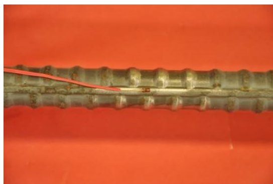
写真-4.27 ひずみゲージ貼り付け状況
