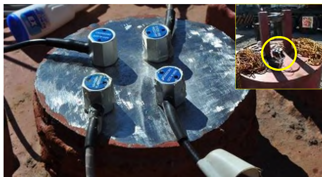
写真-4.23 重錘上面に設置した加速度計
