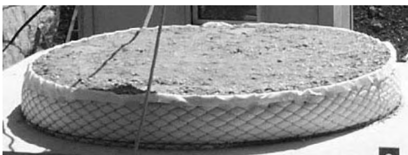
写真-4.1 スイスの大型RC版上の碎石緩衝材の設置状況 11)
