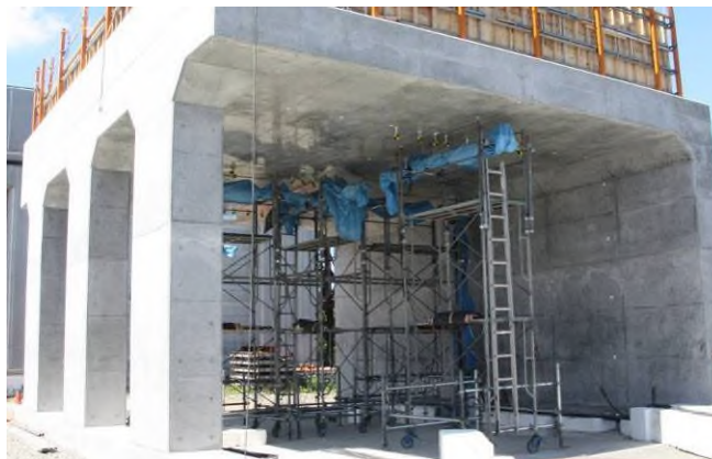
写真-4.26 移動架台を用いた変位計測
