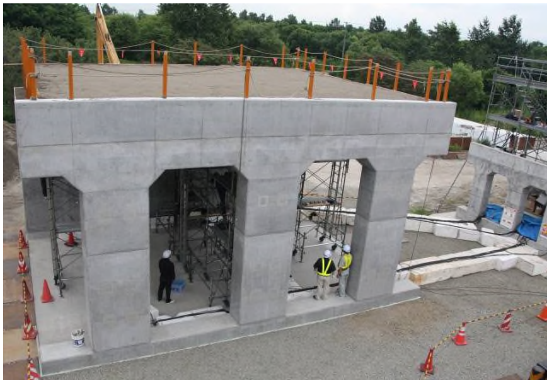
写真-4.19 試験体の外観（敷砂緩衝材）
