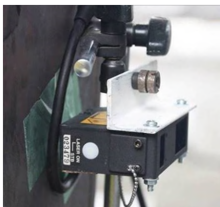
写真-4.25 レーザ式変位計
