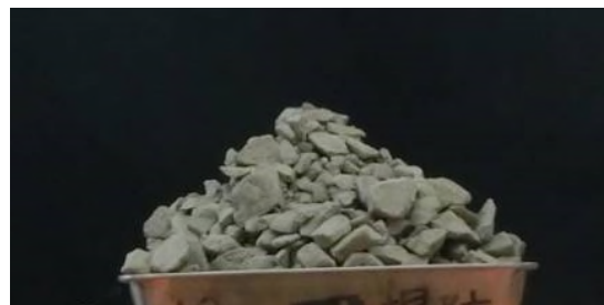
写真-4.33 碎石 安息角度 37.0度
