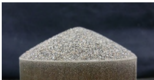
写真-4.32 敷砂 安息角度 27.8度
