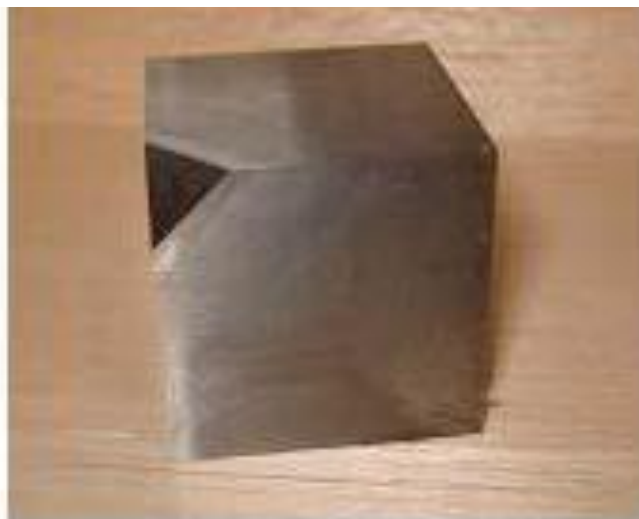
図 2.2.4 二段目アンビル外観
