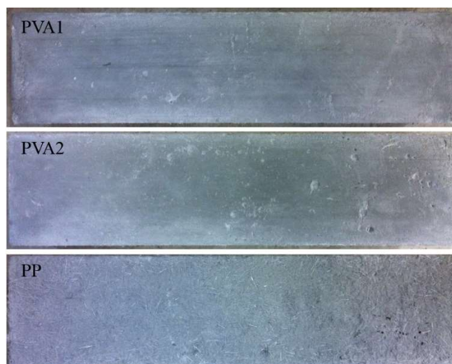
図 5-2-5 供試体表面のスケーリング状態
