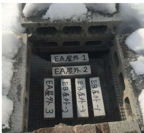
写真 4-3-1 屋外の供試体の養生状態
