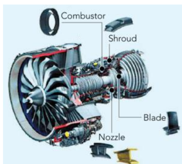
Fig. 1-8 SiC/SiC複合材料の導入された新型GEゼットエンジンパーツ (GE Aviation)
