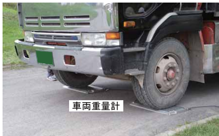
写真 2 トラック重量計測状況
