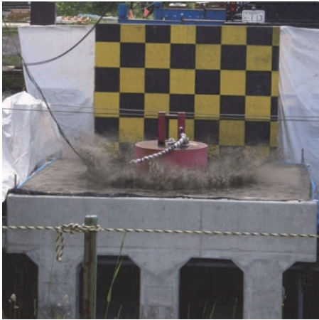
写真-2 覆道模型 (縮尺 2/5) の衝撃実験状況 (S50-W10-H10.0 実験状況) 6)
