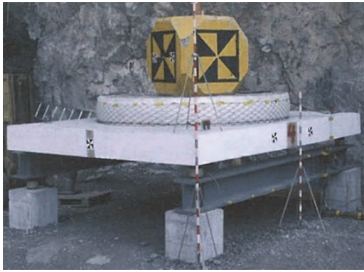
写真-8 スイスにおけるRCスラブ衝撃実験状況 16)
