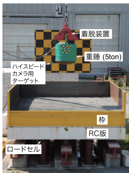
写真-12 実験装置と重錘 (実験状況)
