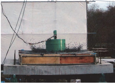
写真-10 砕石緩衝材を用いた RC スラブ衝撃実験状 (G50-W5-H10-漸増繰り返し 4 回目) 17)
