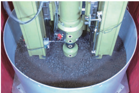
写真-11 室内砕石緩衝材実験状況 19)
