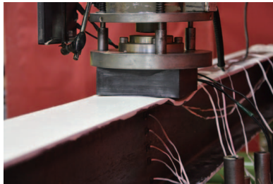
写真-2 上フランジの変形状況 (静載荷実験終了後, L3-S)
