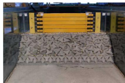
写真-2 波圧測定用のパネル
