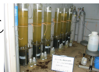
写真-4 溶出実験状況
