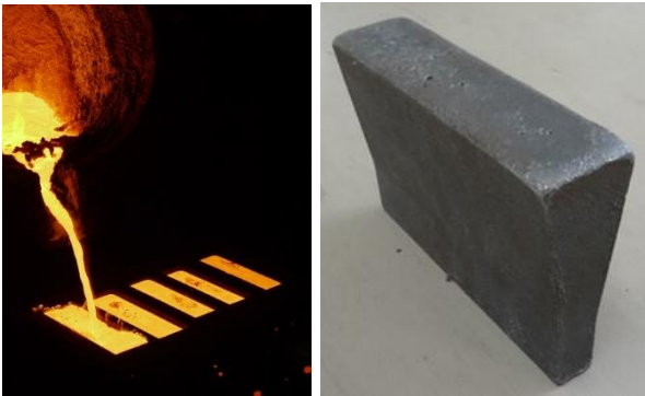
図5 製造したYブロック
