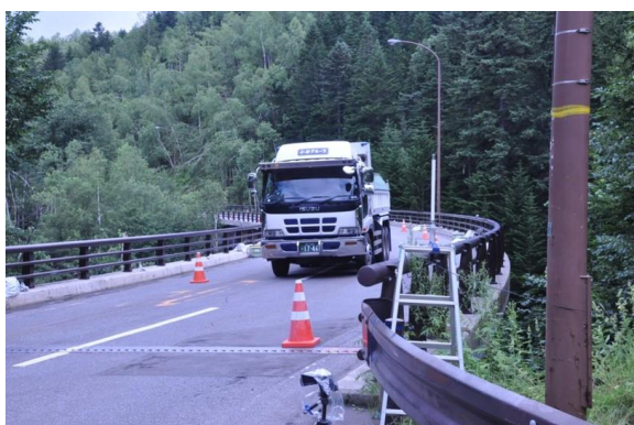
写真 1 大型車両による実験状況
