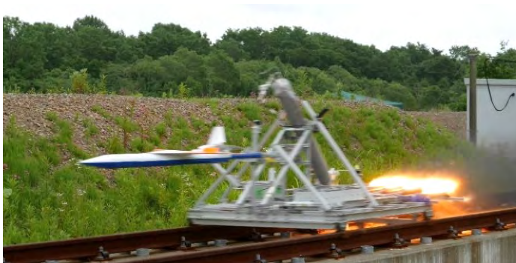
図1 ミニオオワシ搭載走行試験（2016年7月14日，RUN028）
