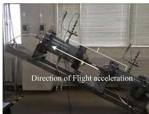
図3 タンクおよび配管系の傾斜の状況
