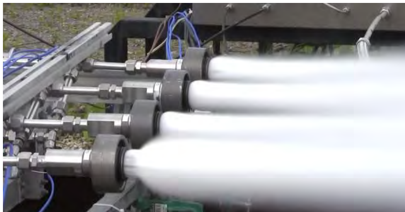
図3 亜酸化窒素によるコールドフローテスト
