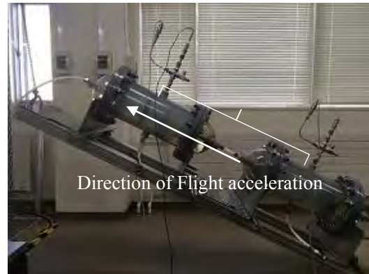
図3 タンクおよび配管系の傾斜の状況
