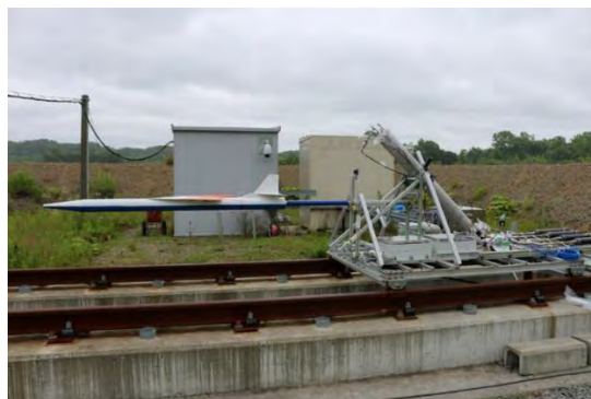
図 1 高速走行台車に設置された 1/3 スケール縮小機体および計測機器（2016 年 7 月）
