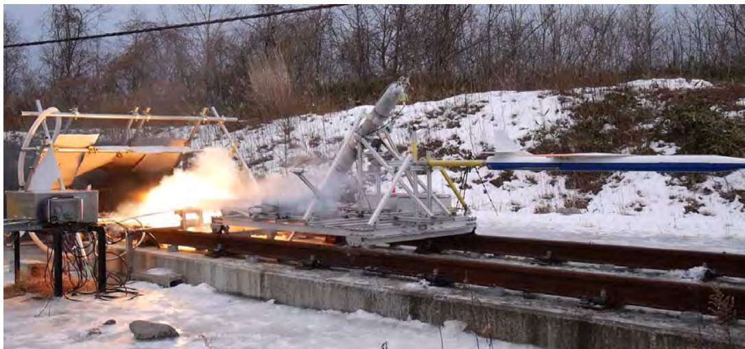
図6 ミニオオワシ機体搭載走行試験画像
