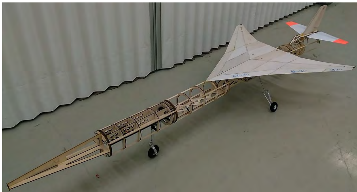
(a) 骨組み構造の仮組みの様子
