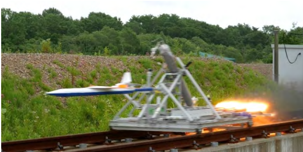
図1 ミニオオワシ搭載走行試験（2016年7月14日，RUN028）
