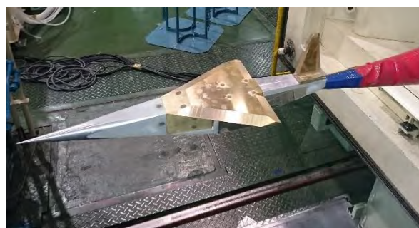
図2 風試模型の遷音速風洞への設置
