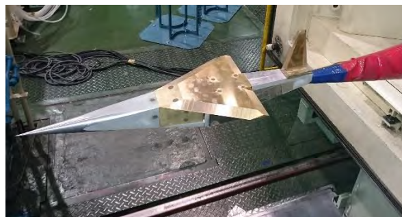
図2 風試模型の遷音速風洞への設置
