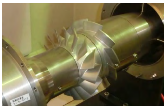
図1 軸流反転ファン実験装置（ケーシングなし）
